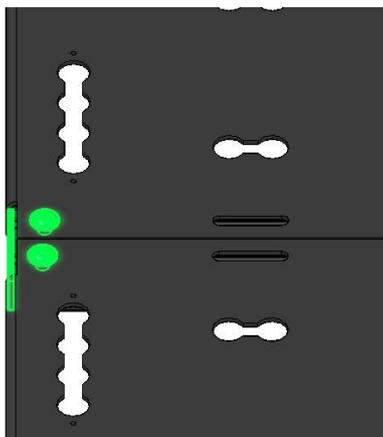
Den schon vorhandenen Nutenstein mit dem Schraubenzieher in die Mitte schieben und einen neuen auf das Loch der zuvor entfernten Schraube. (Bild 2)
